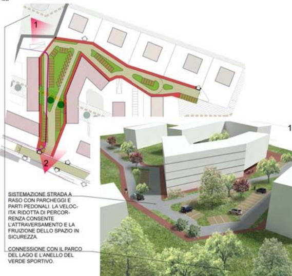
SISTEMAZIONE STRADA A RASO CON PARCHEGGI E PARTI PEDONALI. LA VELOCITÀ RIDOTTA DI PERCORRENZA CONSENTE L'ATTRAVERSAMENTO E LA FRUIZIONE DELLO SPAZIO IN SICUREZZA.
